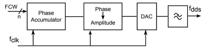
Fig. 7. DDS Block Diagram
